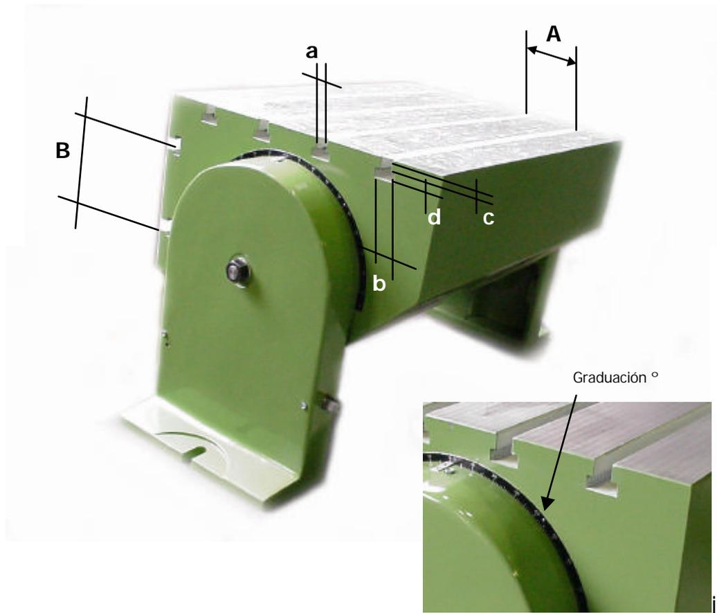
Graduadas y con 2 superficies útiles angulares ranuradas en T que pueden variar A voluntad hasta 180°, por medio de tornillo sin fin y con regleta milimetrada.
